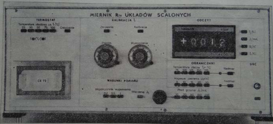
Rys. 5. Miernik rezystancji termicznej układów scalonych
